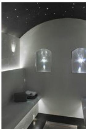
Для влажных помещений, как например паровой бани, мы изготавливаем профильные светодиодные светильники IP65 и IP67 как с белым светом, так и со светодиодами RGBW. Светильники изготавливаются по заказу нужной длины. Максимальная длина светильника 2 м. Блоки питания на стр. 57-58.
